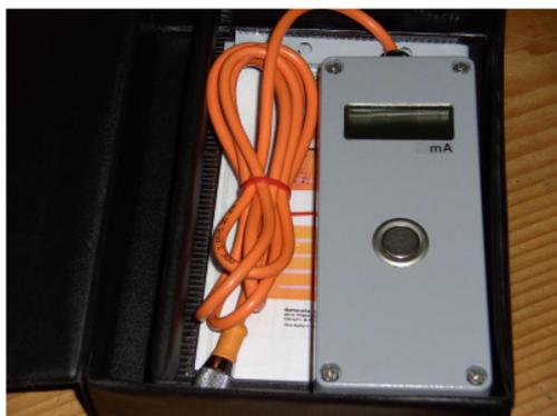
Handablesegerät, 4 stellige LCD Anzeige in mA, mit 1m Kabel und M12 Stecker, IP65
